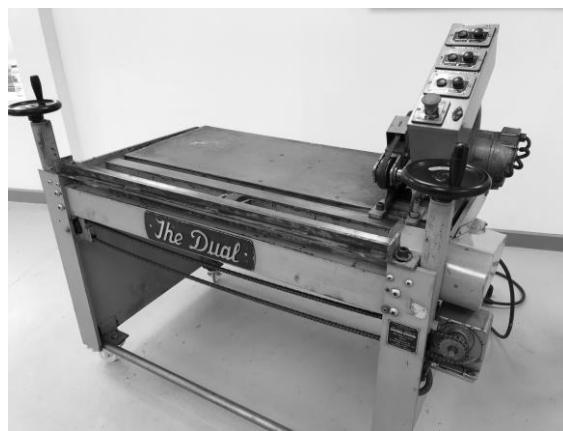
電氣化されて現行機のベースとなった研磨機
